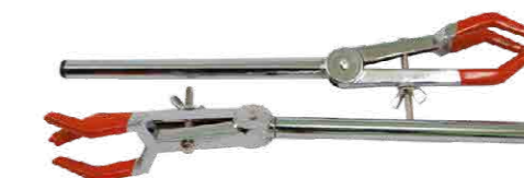
Лапка трёхпалая (для холодильников), максимальный захват – до 60 мм.
